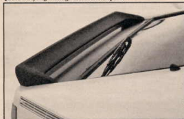
Quattro-Heck: Luftleitwerk aus Hartgummi
